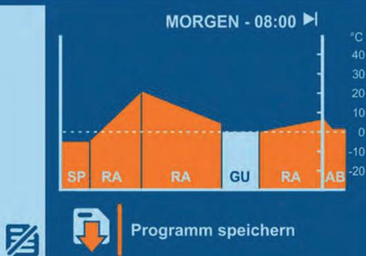
Mit der KLIMA-TOUCH-Steuerung lassen sich die einzelnen Prozesse durch eine Programmverlaufskurve abbilden. So erhalten Sie eine visuelle Darstellung der laufenden Prozesse innerhalb des GUV.
