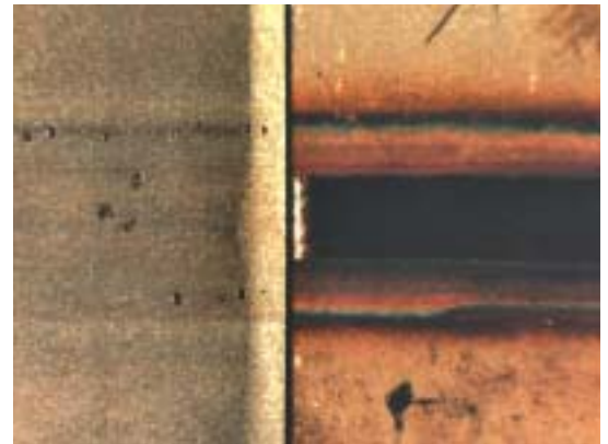
Abb. 8: Gestrahlte Proben nach der Korrosionsprüfung. Deutlich erkennbar ist, dass der Lochfraßangriff entlang der Schweißnaht und der Wärmeeinflusszone verläuft
